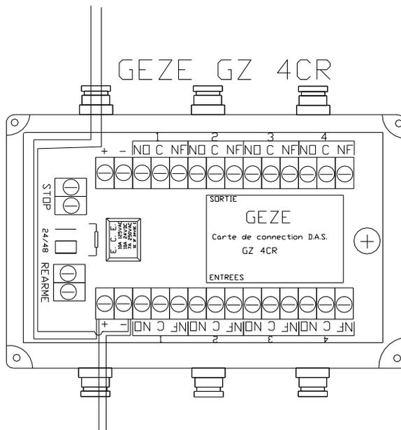
Assembler en faisant une épissure les fils + d'entrée et de sortie Puis câbler uniquement sur le plus du bornier entrée.
