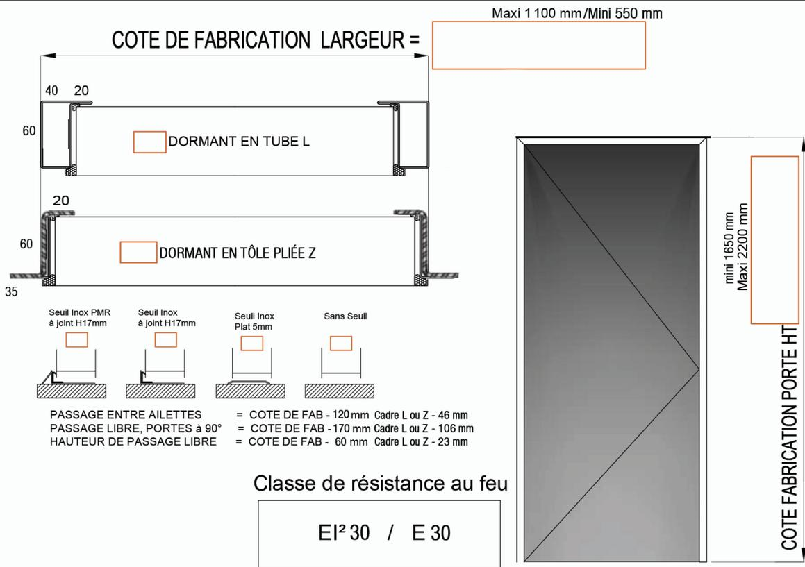
COTES DE FABRICATION = COTE VIDE MACONNERIE - 10mm en largeur et -5mm en hauteur
