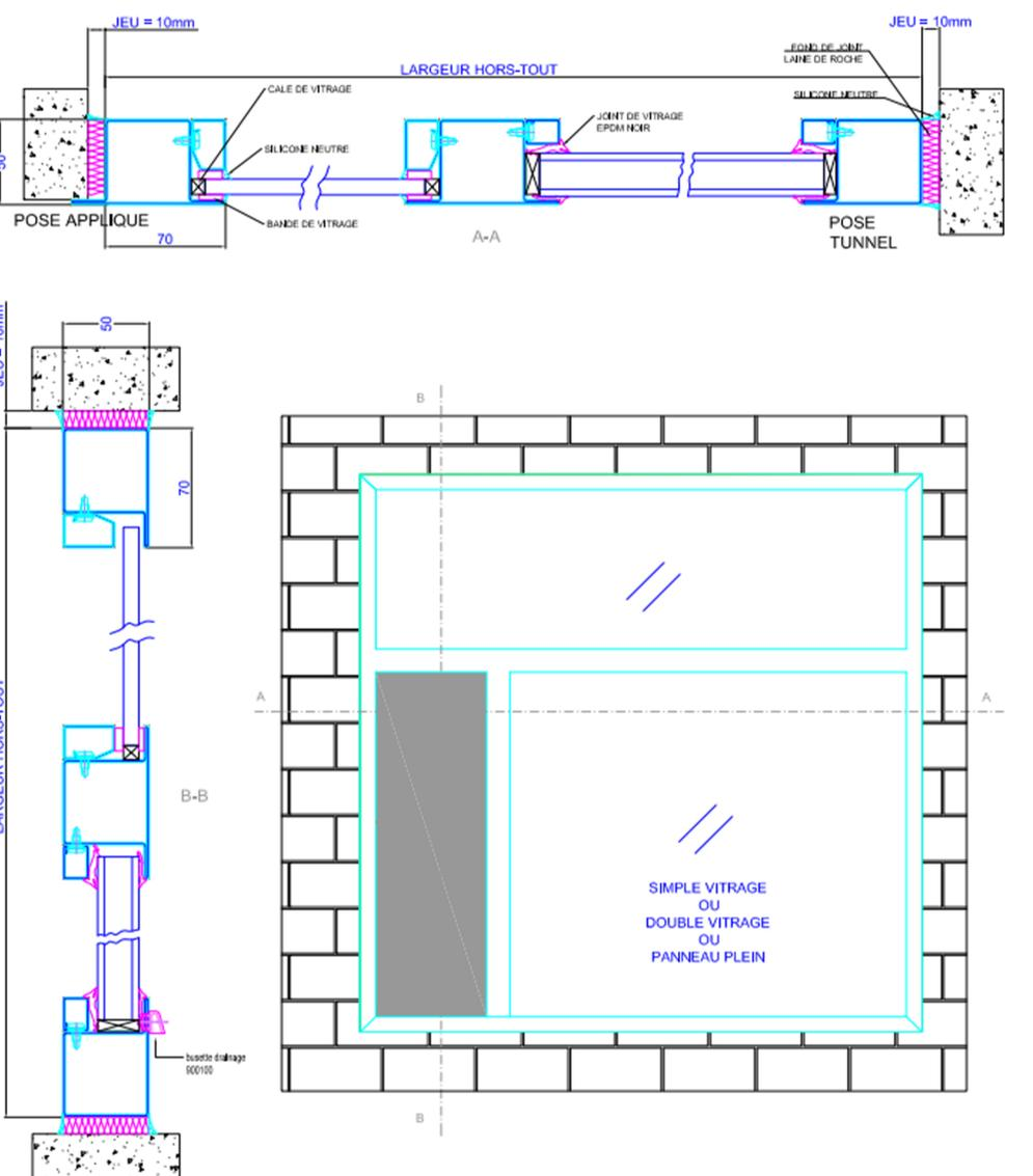
Plan d'un châssis fixe/baie vitrée conçu à partir de profilés Forster Presto.
