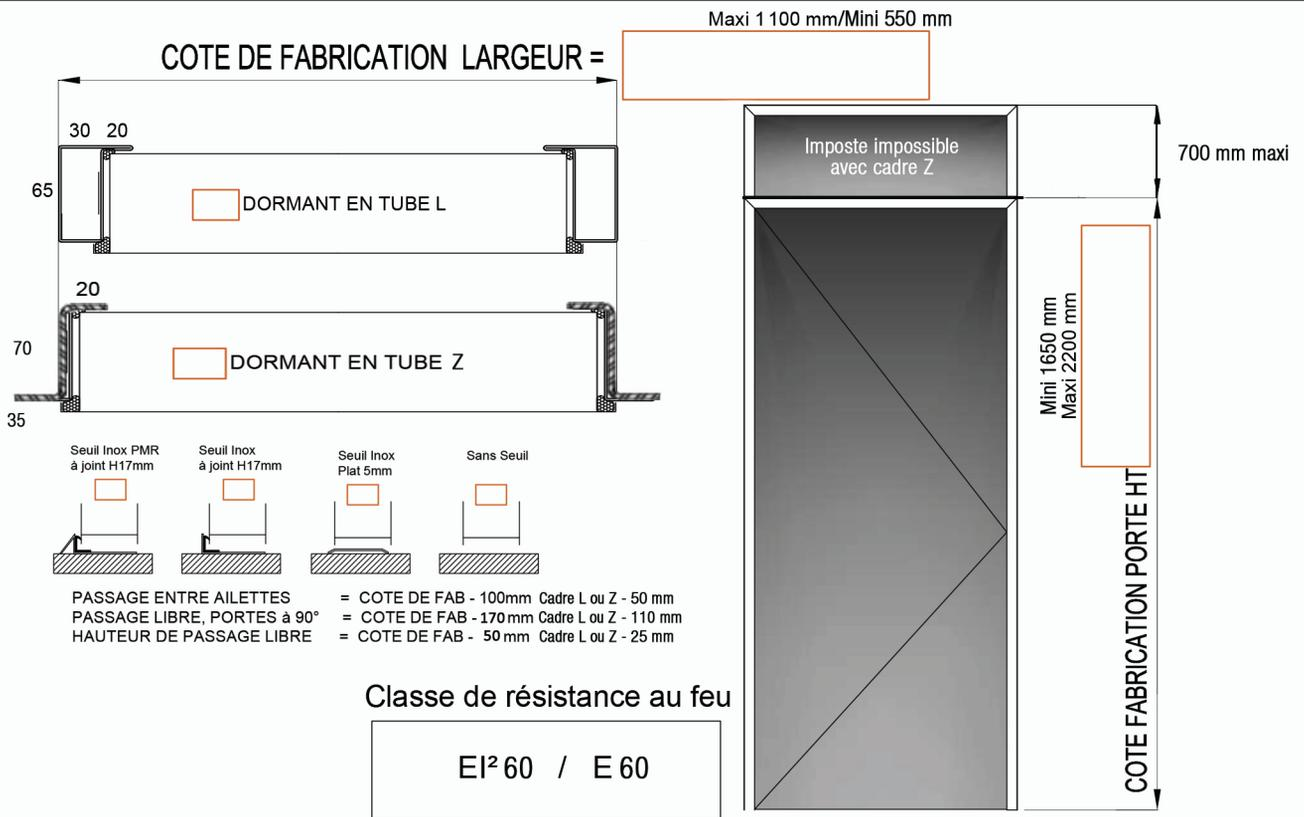
COTES DE FABRICATION = COTE VIDE MACONNERIE - 10mm en largeur et -5mm en hauteur
