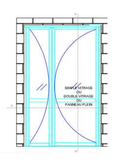
Plan d'une porte par-flamme 2 vantaux sur pivots conçue à partir de profilés Forster Presto.
