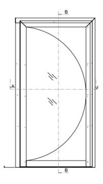
Plan d'une porte par-flamme 1 vantail Noflam sur pivot conçue à partir de profilés Forster Presto.
