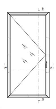
Plan d'une fenêtre par-flamme Noflam conçue à partir de profilés Forster Presto.
