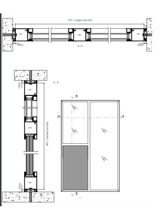
Plan d'un châssis/baie vitrée pare-flamme Noflam conçu à partir de profilés Forster Presto.
