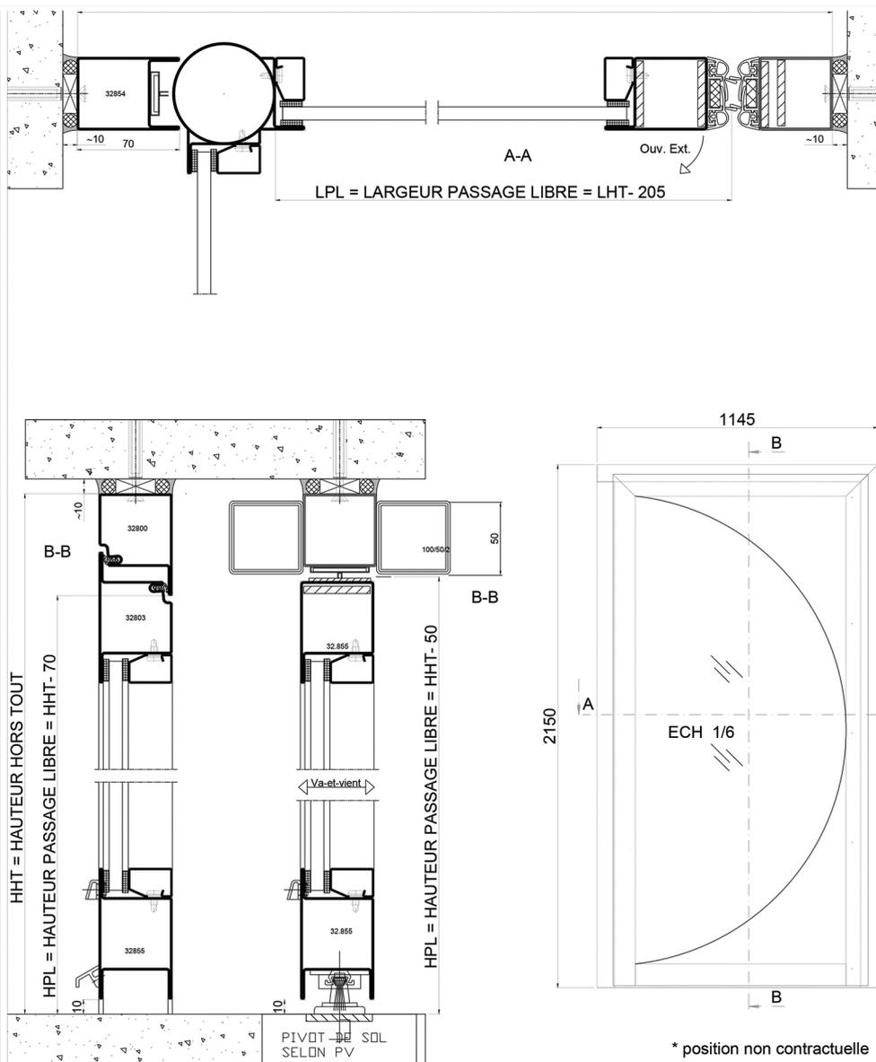
Plan d'une porte par-flamme 1 vantail Noflam sur pivot conçue à partir de profilés Forster Presto.
