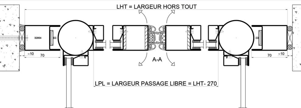
Plan d'une porte par-flamme 2 vantaux sur pivots conçue à partir de profilés Forster Presto.
