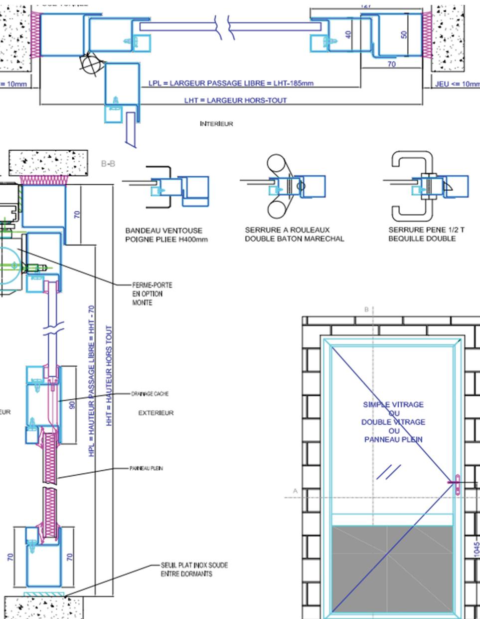
Plan d'une porte vitrée 1 vantail Hallin conçue à partir de profilés Forster Norm.
